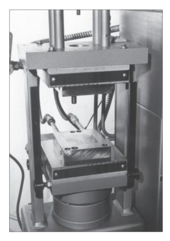
Fig. 28–37. MBA Methocel Javette heat mold, open. MBA photo.
