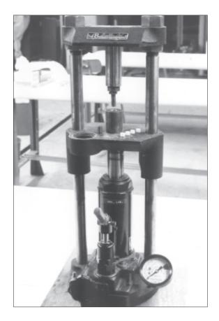
Fig. 28–35. MBA Methocel/tungsten Javette nose preform mold. MBA photo.
